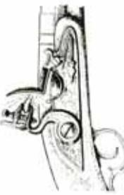
En kraftig hane sätter en skruvinfästning som hiller i flintsten. När hanen frigörs slår flintstenen mot fängspannans lock och alstrar gnistor varvid knuet i bospipan antänds. Flintlagsgevär kom till användning i slutet av 1600-talet och fanns med in i 1800talet då den ersattes med knallhatt antändning.
