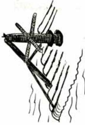
I Näcksjön användes en enklare typ av spel-flotte för att spela fram stockarna till dammen vid Näckåns ut-lopp. Denna spelfflotte användes på samma sätt som spelekan dvs. att flotten låg still och drog "grimman" till sig.
